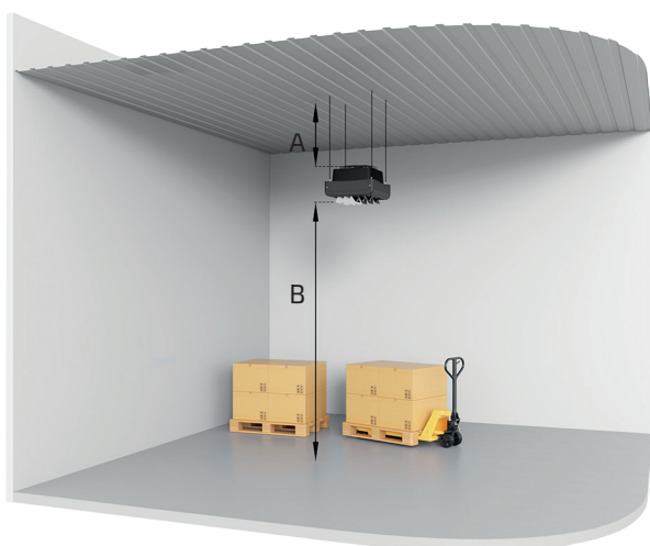
Расстояния при установке
