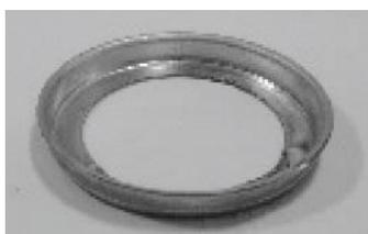
При использовании дымоходного комплекта длиной **более 1 метра** необходимо удалить диафрагму на выходе из котла. Диафрагма **применяется**, если длина коаксиального дымохода составляет не более 1 метра.
