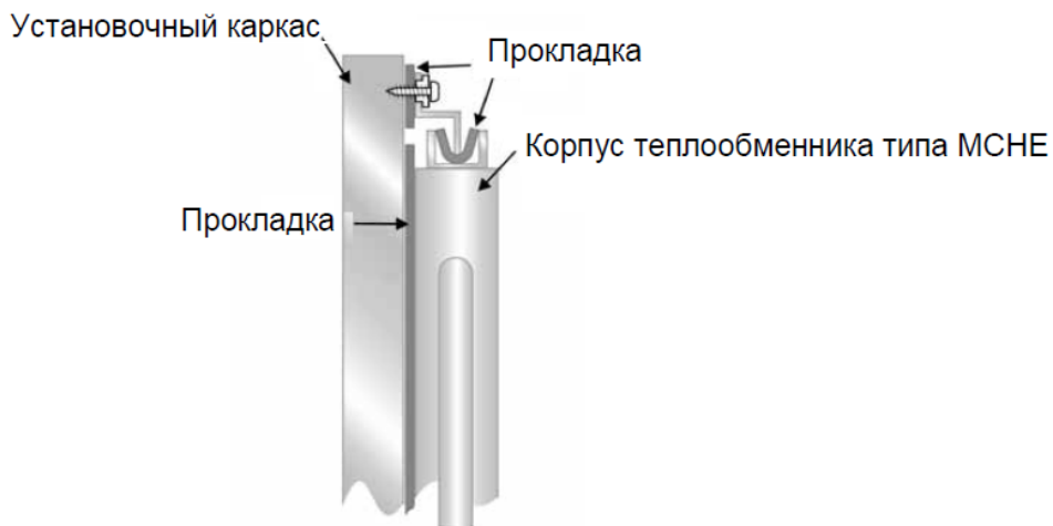
Монтаж теплообменников микроканальных типа МСНЕ.
