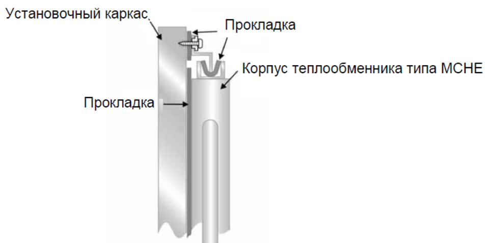
Монтаж теплообменников микроканальных типа MCHE.
